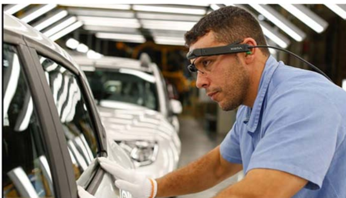
Figura 2: Linha de produção Renault, utilização de tecnologia de realidade aumentada para garantia de qualidade
